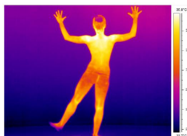
Figura 5: Muestra de un termograma del cuerpo humano, paleta escogida “iron”.
